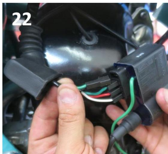
11. Montate il cavo per la candela nella centralina CDI con il relativo cappuccio in gomma. Questa operazione è molto più facile se viene compiuta prima di montare la CDI sul telaio. Ci sono 4 fili che escono dallo statore. Tre di questi vanno alla centralina CDI, mentre il giallo fornisce la corrente per le luci.
