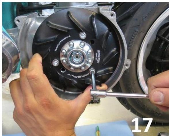
Rimontate ora la ventola. Per comodità abbiamo studiato un sistema che prevede una sola posizione per il montaggio, ottenibile allineando i fori **(vedi foto 16)**. Fissate la ventola utilizzando le 3 viti a brugola da 5mm **(vedi foto 17)**. *Al momento, non è necessario applicare Loctite o serrare con forza le viti, finché l'accensione non è stata messa in fase.*
