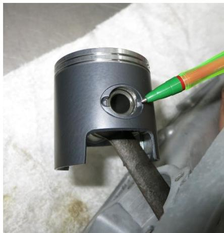
5. Montate ora le fasce sul pistone e un solo anello di tenuta. Raccomandiamo l'utilizzo del nostro [attrezzo per montare gli anelli di tenuta](#), da 16mm in questo caso. Questo incredibile utensile può aiutarvi nelle noiose operazioni di montaggio degli anelli di tenuta, come mostrato in questo [video sul nostro canale YouTube](#).
