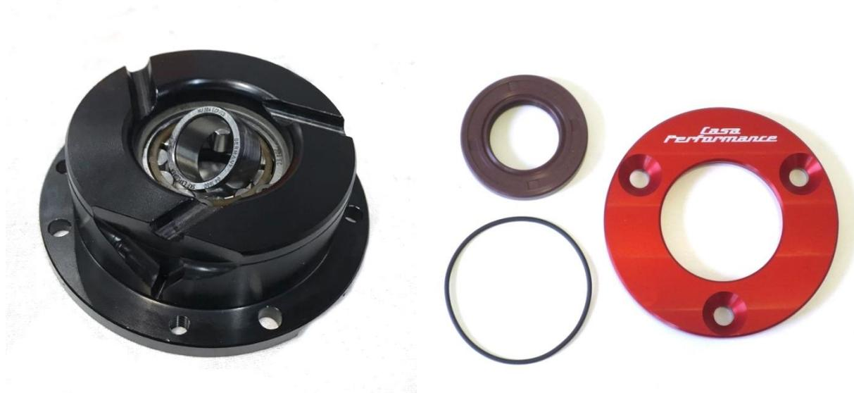
Abbiamo prodotto al CNC anche la [flangia per il paraolio lato pignone](#) (sopra, a destra). Ha un OR in Viton supplementare per garantire la massima tenuta ed un paraolio doppio labbro, sempre in Viton (potete scegliere il paraolio dedicato per i cambi 3 o 4 marce).
