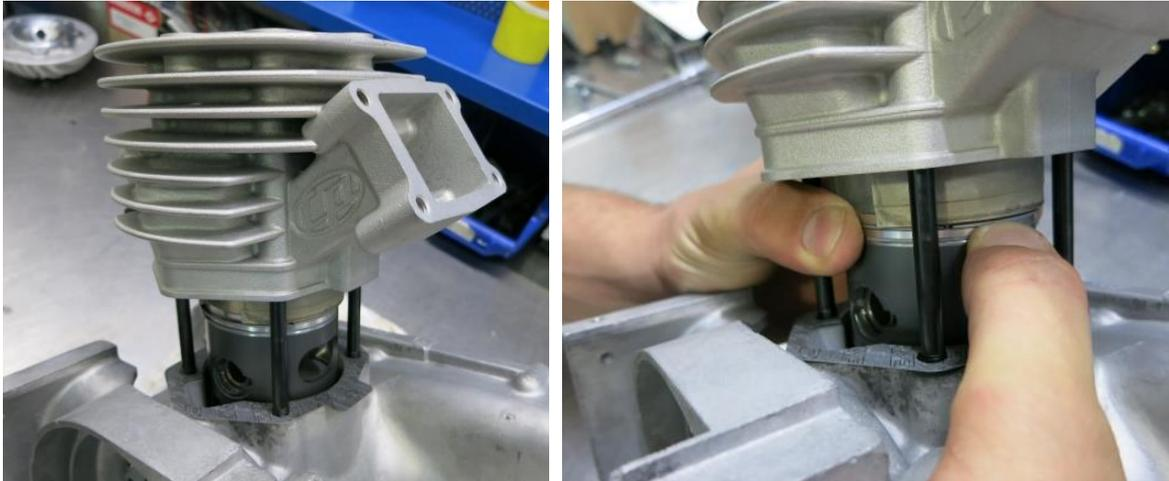
9. Comprimate leggermente ogni fascia per chiuderla, permettendo al cilindro di scivolarci sopra. Una volta che entrambe le fasce correttamente in sede nella canna del cilindro, fate scivolare quest'ultimo fino a chiudersi completamente sulla guarnizione del basamento. Fate ruotare l'albero motore per verificare che il pistone si muova liberamente nel cilindro.
