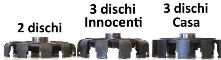
Il cestello della frizione, che si inserisce sul cluster del cambio, è disponibile con il foro calettato centrale PICCOLO o GRANDE. Quando scegliete il cestello della frizione assicuratevi sempre che sia per frizioni 3 dischi e che il foro calettato sia della giusta misura per il vostro cluster.
