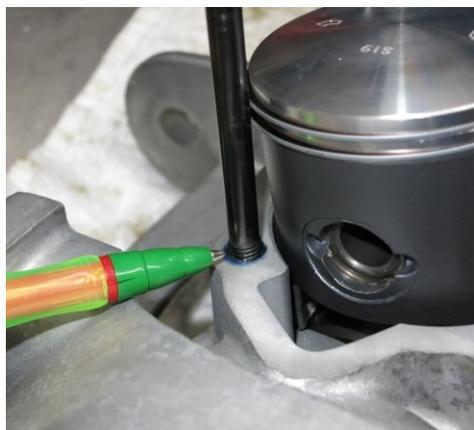
6. Se avevate precedentemente tolto i prigionieri "corti" in uso nei cilindri 50/75cc, montate adesso quelli di tipo lungo, applicando sui filetti più corti, da avvitare negli appositi fori sul carter, una goccia di 'Loctite Frenafilletti Medio' (o similari). Pulite ogni eccesso di prodotto dai prigionieri una volta montati.
