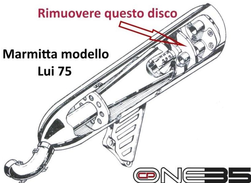
**Esempio 1 per la gamma Lui:** usando una marmitta originale Lui 75cc, la potenza massima sarà di circa **10CV** alla ruota. Semplicemente rimuovendo il disco interno (come illustrato nel Lambretta Tuning Manual degli anni '60), otterrete un incremento di potenza pari al 10%.
