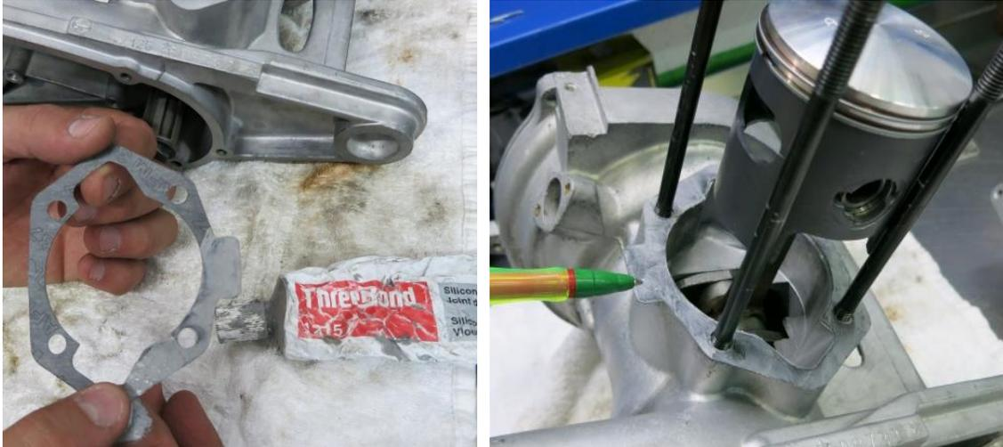
13. Smontate adesso il cilindro e sfilate la guarnizione del basamento, avendo cura di non romperla sfilandola. Applicate un leggero strato di grasso (meglio se ad alta temperatura per cuscinetti) sulla guarnizione del basamento e rimettetela in posizione. *In alternativa al grasso, potete usare un ottimo sigillante come il [Threebond](#).*
