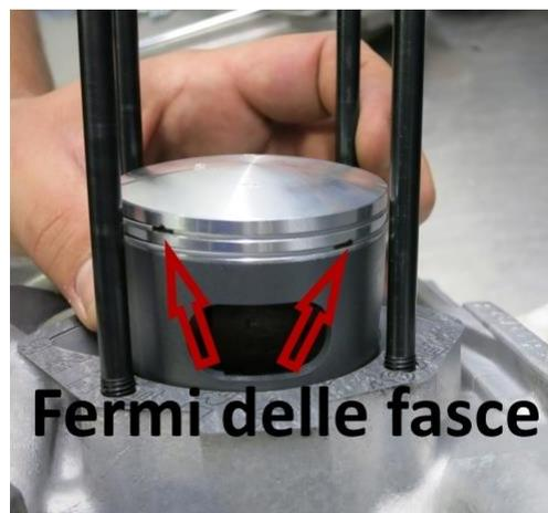
8. Misurate adesso la banda di squish. Ovvero, in termini molto semplici, lo spazio disponibile tra la testa ed il cielo del pistone, quando quest'ultimo è al PMS. Questa operazione va eseguita "a secco", quindi senza l'uso di sigillanti o lubrificanti vari. Il kit **CP One35** viene fornito con 2 guarnizioni per il basamento,
