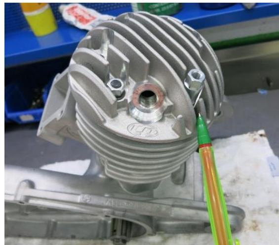
Stringete i dadi seguendo il classico schema a croce, serrando poi con chiave dinamometrica a **15Nm**, seguendo lo schema in **ROSSO**. Adesso inserite le rondelle spezzate e quindi quelle piane nelle 3 viti a brugola M6. Serratele a **11Nm**, seguendo la sequenza indicata in **VERDE**. Quindi, ancora una volta, ruotate l'albero motore, assicurandovi che tutto giri liberamente.
