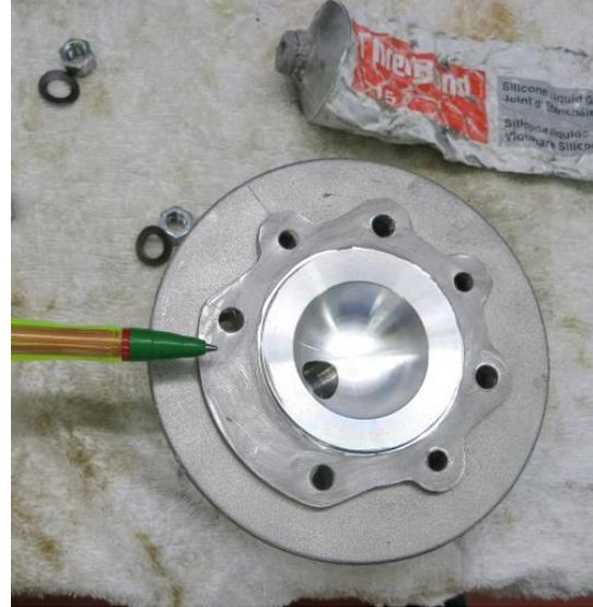
15. Adesso, passate al piano testa del cilindro, che andrà cosparso di un leggero strato di sigillante [Threebond](#). Montate la testa, assicurandovi che sia perfettamente in sede. *Accertatevi che la testa, ad incasso, sia perfettamente inserita nel cilindro!*
