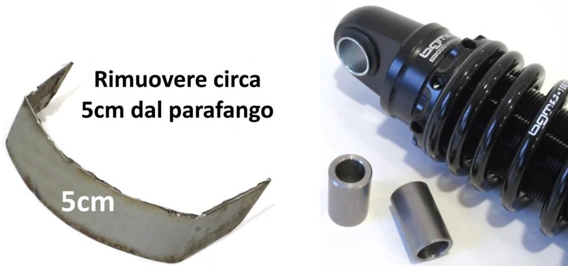
Sulla gamma Lui, quando si monta un cilindro più grande (100cc, 125cc o il **CP One 35**), la cuffia del cilindro si sposta molto vicina al telaio e si rischia che le parti della carrozzeria entrino in contatto. Per evitare questa eventualità, consigliamo di montare un [ammortizzatore posteriore BGM per Lambretta Serie 3/SX/DL](#), utilizzando [2 apposite boccole](#) prodotte da Casa Performance.
