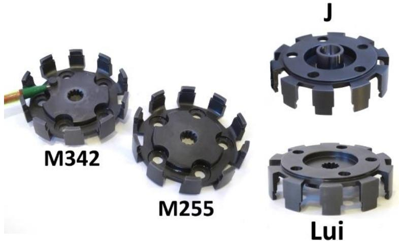
*La nuova generazione di cestelli frizione Casa Lambretta, realizzati con tecnologia CNC, ha la parte inferiore piatta, perfetta se volete installare in tutta tranquillità una frizione a 4 dischi.*
