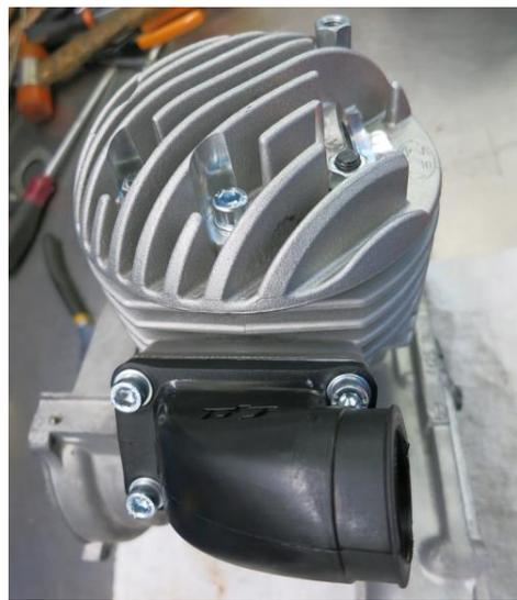
16. Inserite l'apposita guarnizione sul pacco lamellare, quindi inseritelo nel cilindro. Utilizzate adesso l'altra tra il pacco lamellare e l'apposito collettore in gomma, serrate con le 4 viti a brugola e le relative rondelle fornite, senza dimenticare una goccia di 'Loctite Frenafletti Medio' (o similare).
