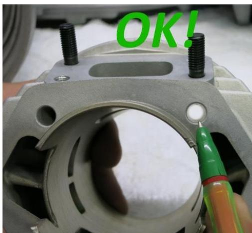
7. Passate adesso ai 4 prigionieri di scarico. Anche in questo caso applicate una goccia di 'Loctite Frenafilletti Medio' (o similare) sulla filettatura **PIU' CORTA**, che andrà inserite nei fori sul cilindro.
